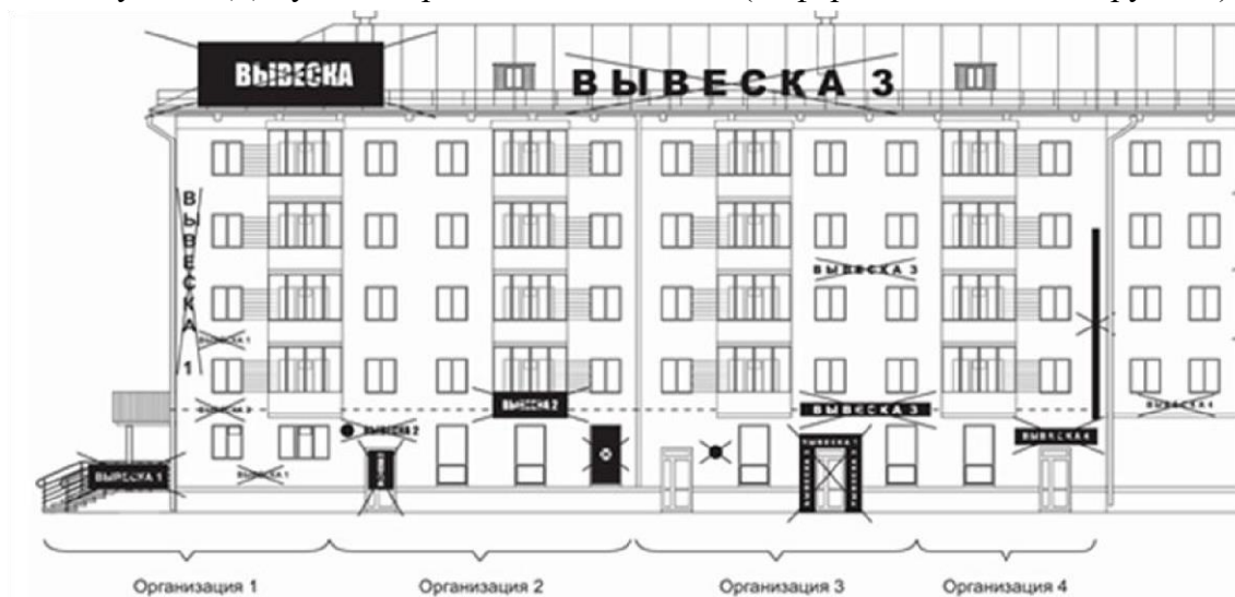
Рисунок 2. Недопустимое размещение вывесок (информационных конструкций)
