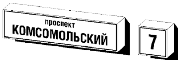
Глубина светового короба 80-130 мм.
